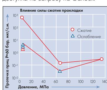
Тест демонстрирующий влияние превышения давления на GYLON Standard 90 / 50 / 2; Тест между сжимающими пластинами.
